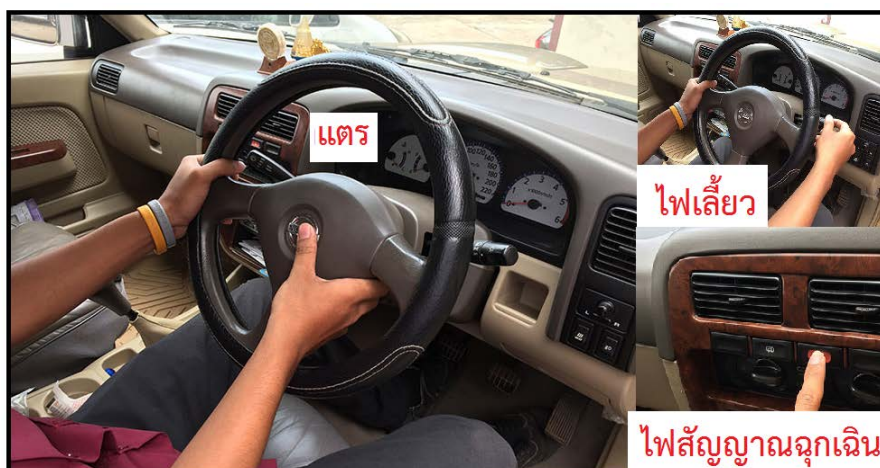
รูปที่ 3.26 แสดงการตรวจสอบการทำงานของแตร ไฟเลี้ยวและไฟสัญญาณฉุกเฉิน (ที่มา : ชินภัทร แก้วโกมินทวงศ์. 2559)
