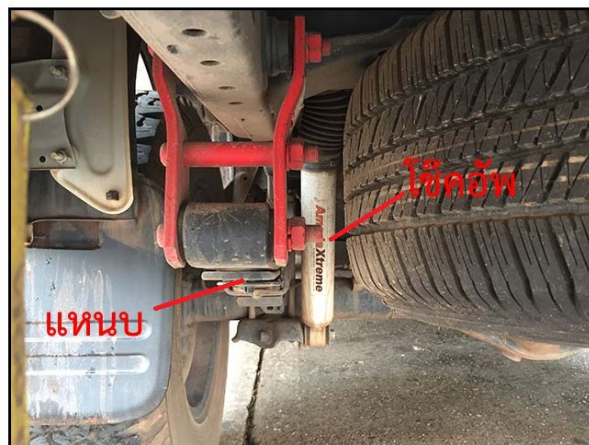
รูปที่ 3.18 แสดงการตรวจสอบความเสียหายของแหนบและโช้คอัพ (ที่มา : ชินภัทร แก้วโกมินทวงษ์. 2559)
