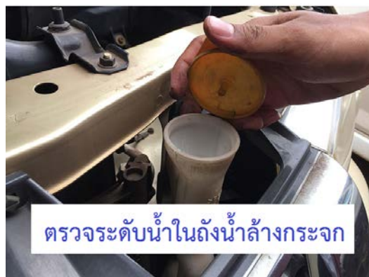
รูปที่ 10.19 แสดงการตรวจระดับน้ำในถังน้ำล้างกระจกและเติมให้พอเพียงอยู่เสมอ (ที่มา : ชินภัทร แก้วโกมินทวงศ์. 2559)
