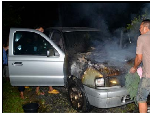
รูปที่ 7.39 แสดงอุบัติเหตุเมื่อเกิดไฟช็อตหรือสายไฟลุกไหม้ในเครื่องยนต์ (ที่มา : https://www.thairath.co.th )
