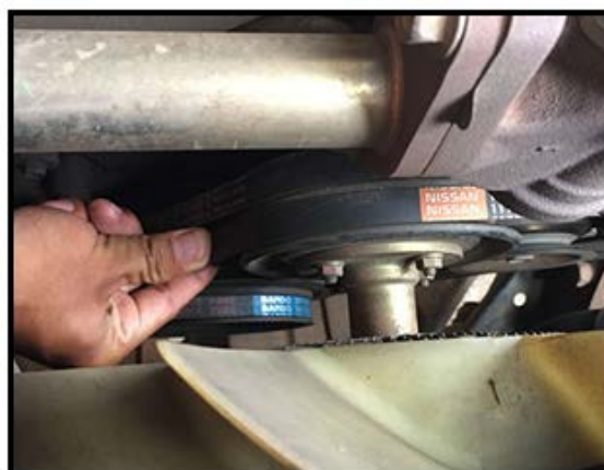
รูปที่ 3.34 แสดงการตรวจสอบความตึงของสายพาน (ที่มา : ชินภัทร แก้วโกมินทวงศ์. 2559)
