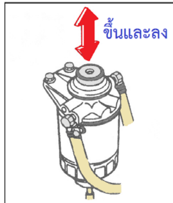
รูปที่ 10.13 แสดงการไล่อากาศออกจากระบบน้ำมันเชื้อเพลิง (ที่มา : ชินภัทร แก้วโกมินทวงศ์. 2559)
