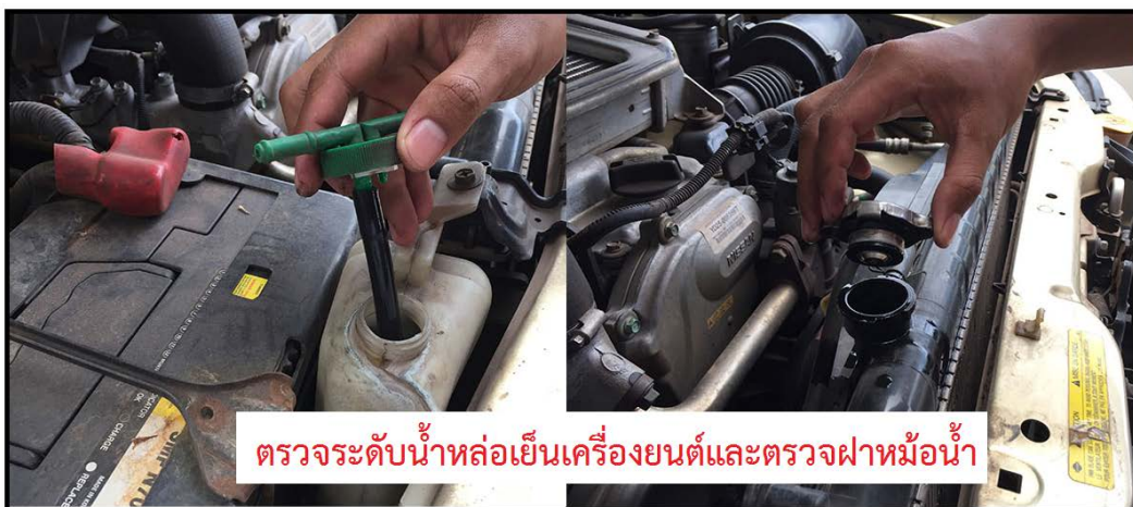
รูปที่ 3.36 แสดงการตรวจระดับน้ำหล่อเย็นเครื่องยนต์และตรวจฝาหม้อน้ำ (ที่มา : ชินภัทร แก้วโกมินทวงศ์. 2559)
