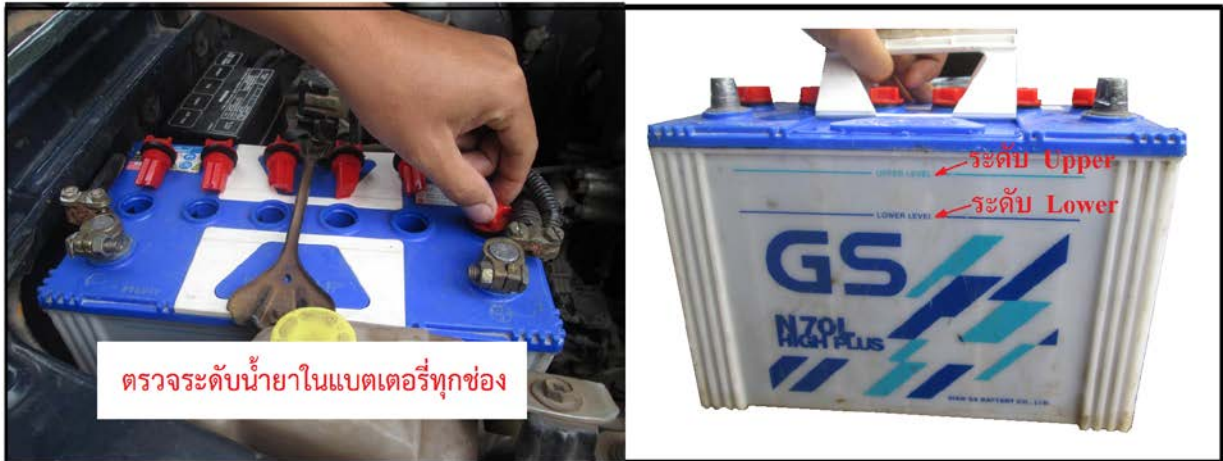
รูปที่ 3.37 แสดงการตรวจระดับน้ำยาในแบตเตอรี่ทุกช่อง (ที่มา : ชินภัทร แก้วโกมินทองษ์. 2559)
