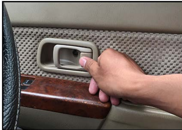
รูปที่ 3.30 แสดงการตรวจสอบการทำงานที่ล็อกประตูรถทุกบาน (ที่มา : ชินภัทร แก้วโกมินทวงศ์. 2559)
