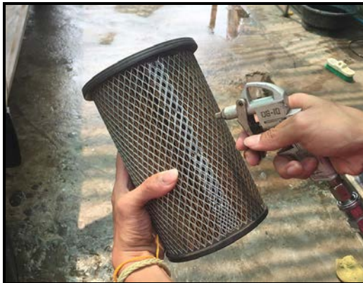
รูปที่ 10.4 แสดงการตรวจสอบและทำความสะอาดไส้กรองอากาศ (ที่มา : ชินภัทร แก้วโกมินทวงษ์. 2559)
