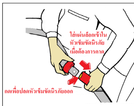
รูปที่ 3.13 แสดงการคาดเข็มขัดนิรภัยและการปลดเข็มขัดนิรภัยแบบยึด 2 จุด ไม่มีชุดดึงกลับ (ที่มา : ชินภัทร แก้วโกมินทวงษ์. 2559)
