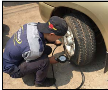
รูปที่ 10.26 แสดงการตรวจวัดความดันลมยางรถยนต์ (ที่มา : ชินภัทร แก้วโกมินทวงศ์. 2559)
